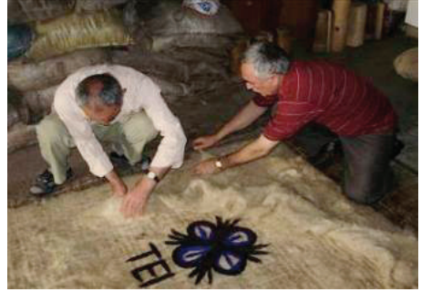
KENARLARININ DÜZELTİLMESİ, YUVARLATILMASI KAYNAŞTIRILMASI
