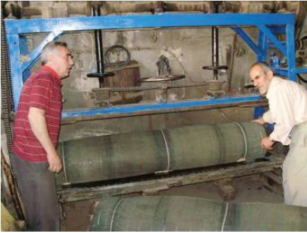
KALIBIN TEPME MAKİNESİNE YERLEŞTİRİLMESİ
