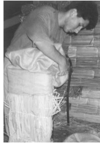
Fotoğraf 3b. Berdi kılflarının geçirilmesi
