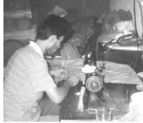
Fotoğraf 3a. Berdi kılflarının dikilmesi
