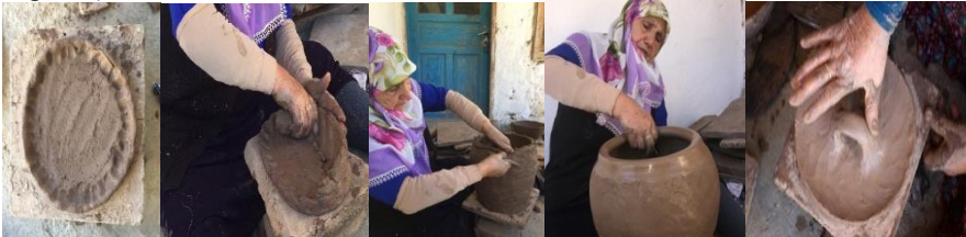
Fotoğraf 2: Güvecin tabanı, gövdesi, dudağı ve kapağının yapımı.
