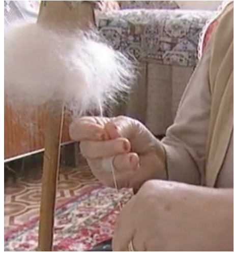
Fotoğraf 3: Kırkılmış Olan Tiftiklerin Taranması (Solda) ve Eğrilmesi (Sağda)
