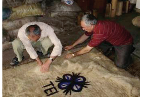
KENARLARININ DÜZELTİLMESİ, YUVARLATILMASI KAYNAŞTIRILMASI
