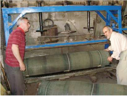
KALIBIN TEPME MAKİNESİNE YERLEŞTİRİLMESİ
