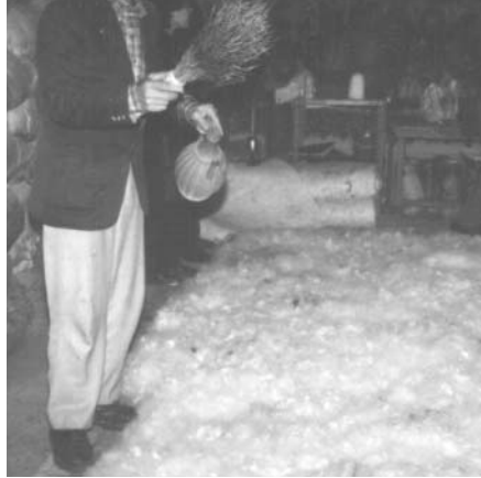
Şekil 8 - Yayılan yünün üzerine su serpilmesi
