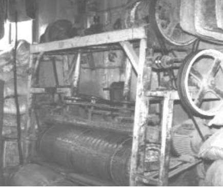
Şekil 12 – Keçenin yapılacak ürün cinsine göre şekil verilip kenarlarının düzeltilmesi.
