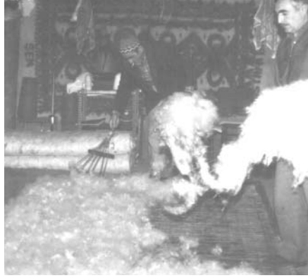
Şekil 7 - Yünün hasır üzerine yayılması
