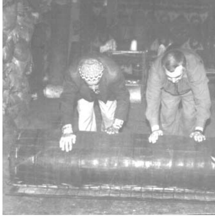
Şekil 9 - Hasırlanmış olan keçenin rulo yapılarak kalıba sarılması
