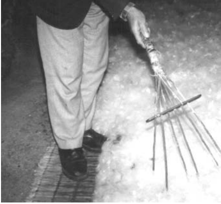
Şekil 1 - Yünün dağıtılmasında kullanılan sepki.
